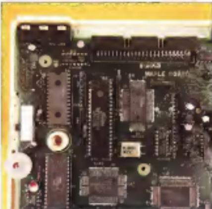
A sinistra: il chip di ROM compatibile Intel che si trova sul BIOS da 32 Kbit che controlla l'LF.
